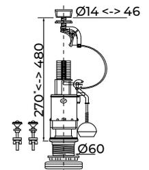
Mécanisme à poussoir à câble
