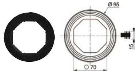
Joint de culot intérieur réservoir M24
