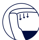
Sans bride La bride est supprimée pour faciliter l'entretien des cuvettes.
