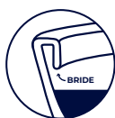
Avec bride L'eau de chasse est propulsée dans la zone en U située en haut de la cuvette. La bride peut être ouverte ou fermée.
